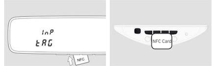
Die Karte wird überprüft. Bei Verwendung einer falschen Unternehmer-Card, erscheint Err Unt.Nr.
